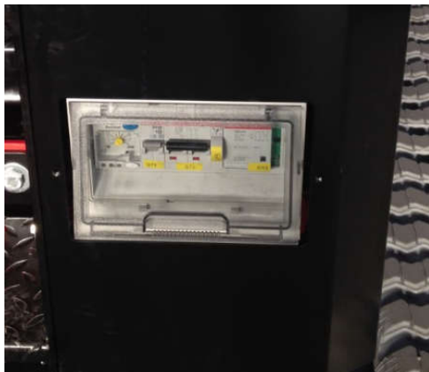
34. Hovedpanel sikringer vekselretter (hvis monteret)
