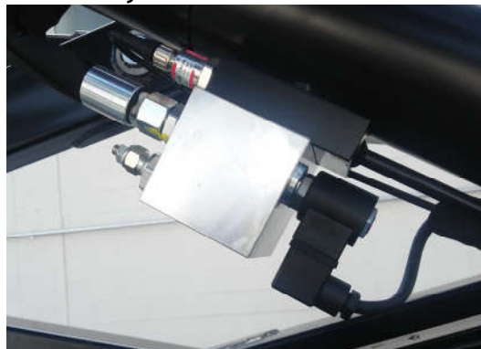
10. Elektroventil på øvre løftesyndre SV19
