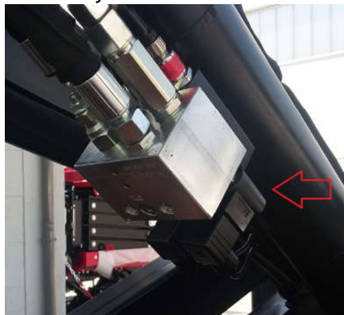
12. Ekstra elektroventil på begge løftesyndre SV21
