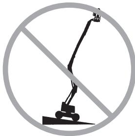
Ikke bruk tiltealarmen som indikator på at maskinen står plant. Tiltealarmen på plattformen utløses kun når maskinen står svært skrått.
