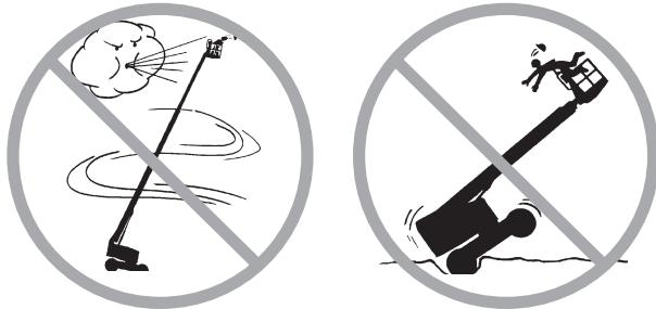
Vær ekstremt forsiktig, og kjør med lav hastighet og med maskinen sammenslått over ujevnt terren, skrot, ustabilt eller glatt underlag og nær hull og skrenter.
