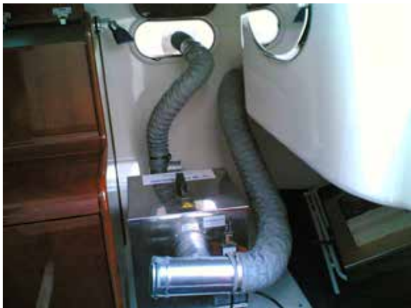
Avfukter installert i fritidsbåt.
