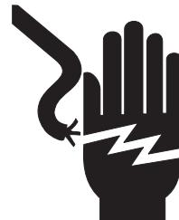
Koble batteriladener kun til et jordet, 3-punkts vekselstrømsuttak.
