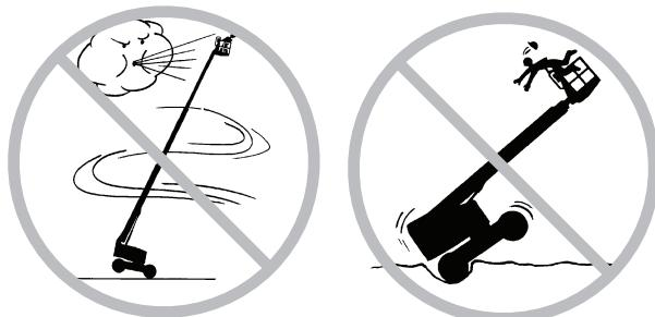
Vær ekstremt forsiktig og kjør med lav hastighet og med maskinen sammenslått over ujevnt terreng, skrot, ustabilt eller glatt underlag og nær hull og skrenter.
